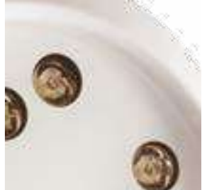
MÓDULO DE 12 LEDS EMBEBIDO EN RESINA
